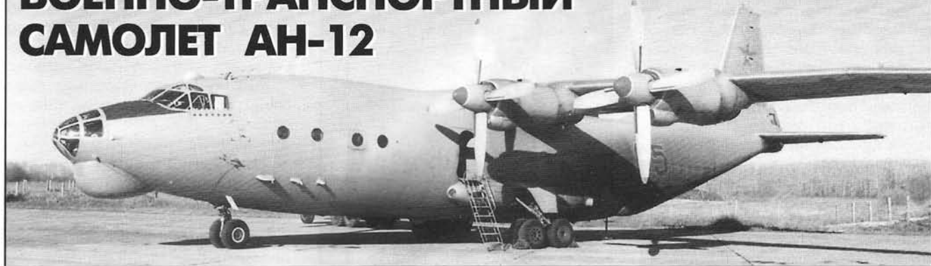
Самолет радиационно-химической разведки Ан-12РХ с кронштейнами крепления фильтрогондол по бортам фюзеляжа
