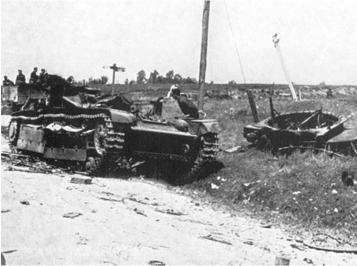
Разрушенный взрывом боекомплекта танк Т-28. Взрывом были сорваны все три башни. Орудийная башня лежит перевернутой рядом с танком.
