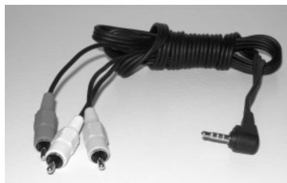
Рис. 1.14. Если в вашей видеокамере имеется AV-порт, вам потребуется специальный кабель. Заметьте, что одиночный штекер состоит из трех колец, каждое из которых служит для передачи одного из трех выходных сигналов
